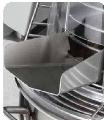
Scivolo inox che facilita l'aggiunta di ingredienti con la macchina in funzione
