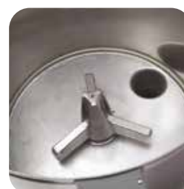
Scarico dell'acqua residua
