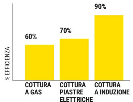
*Energia effettivamente trasmessa al contenuto del recipiente di cottura rispetto alla quantità di riscaldamento prodotta dal sistema (test di laboratorio interni).*
