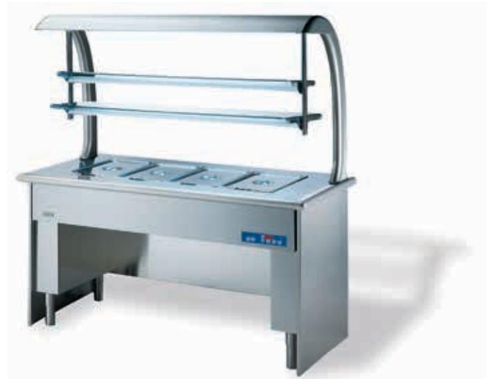
Il piano da 20/10, le pannellature esterne, e la base sono in acciaio inox AISI 304. La struttura è completamente saldata. Le vasche sono raggiate su tutti i lati per una completa e facile pulibilità. Le dimensioni delle vasche sono tali da contenere in lunghezza 3, 4 o 6 bacinelle GN 1/1 con un'altezza massima di 200 mm. I bagnomaria ad acqua sono dotati di sistema automatico di rabbocco dell'acqua: quando l'acqua evapora la vasca viene riempita automaticamente.
